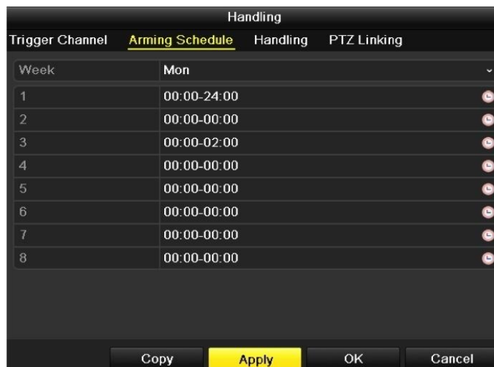
Рисунок 8.8 Установка расписания активности тревожного входа
