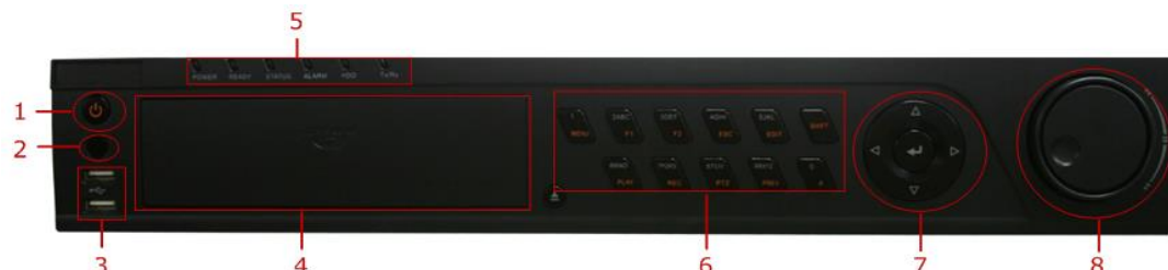
Рисунок 1.1 Передняя панель DS-7300HI-ST&DS-7300HFI-ST
