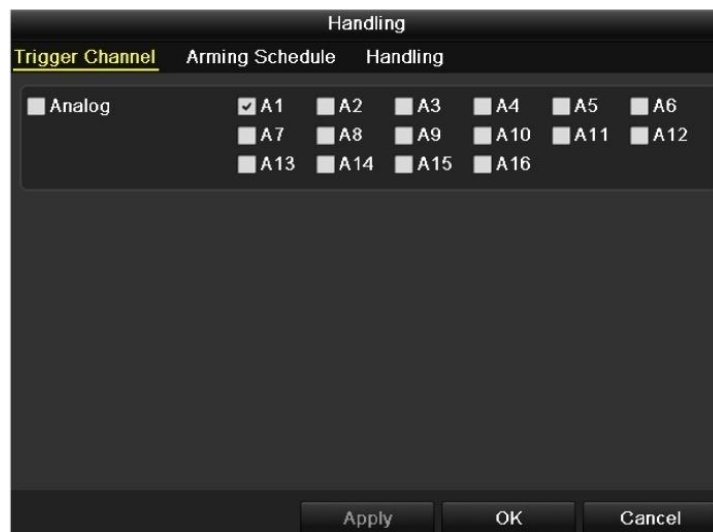
Рисунок 8.3 Установка камер, реагирующих на тревогу
